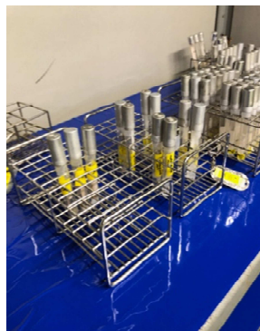
図11 粘着マットによる拡散防止措置
